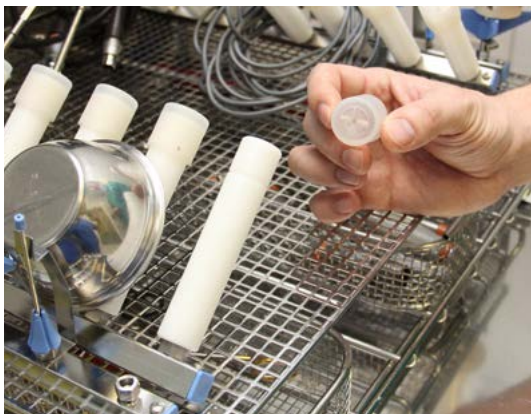
Verschiedene Anschlüsse für Hohlrauminstrumente
